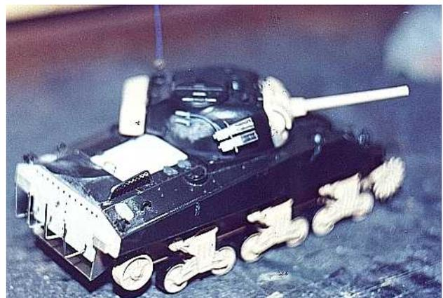
O lançador de fumaça foi feito a partir de cilindros plásticos que vem protegendo as cerdas dos pincéis quando você os compra e plástico estireno esticado no calor. Na placa inclinada nas laterais do tanque, existia uma concha, como de palco de teatro, para refrigeração do motor, mas que o M4A2 não possui. No lugar, eu tive que colocar duas tampas de formato elíptico, bem visíveis na foto, à esquerda. As portas do compartimento do
